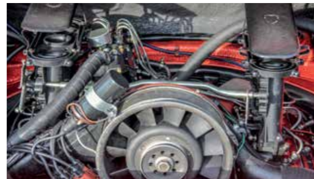
Das 2,7-Liter-RS-Triebwerk mobilisiert 228 Pferdchen.
