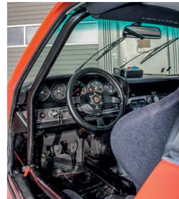
Blick ins Interieur mit Schalensitzen, Käfig und Sportlenkrad
